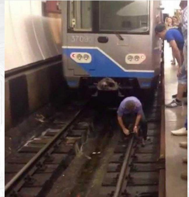
Если пострадавший не обнаружен, то машинист докладывает об этом ДЦХ, снимает закоротку и дает заявку на подачу напряжения на контактный рельс.
