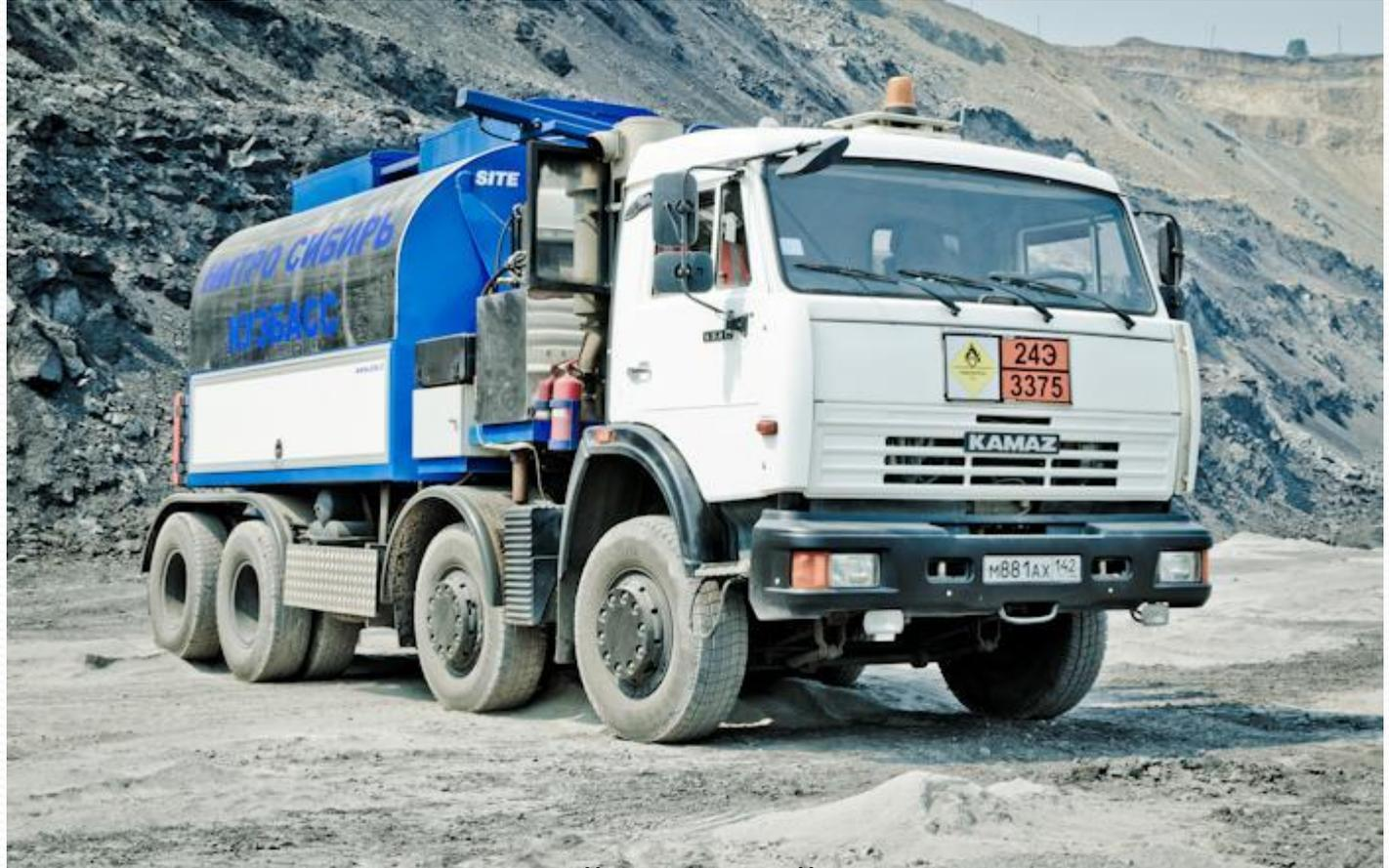
МСЗ-16 (6872) оснащена усовершенствованной системой автоматического регулирования и позволяет транспортировать 16-ти тонный комплект компонентов ЭВВ (эмульсионных взрывчатых веществ) по дорогам России любых категорий в соответствии с требованием технического регламента «О безопасности колесных транспортных средств».
