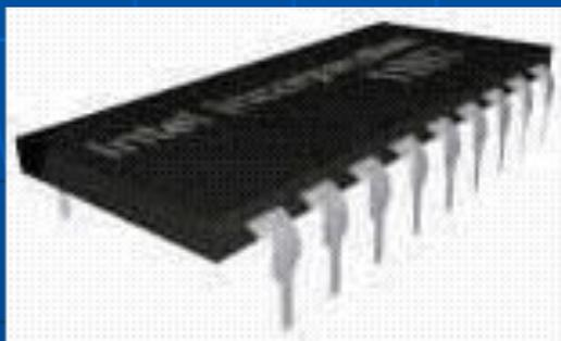
С 70-х годов прошлого века в качестве элементной базы ЭВМ третьего поколения стали использовать **интегральные схемы**. ЭВМ на базе интегральных схем стали более компактными, быстродействующими и дешевыми. Такие мини-ЭВМ производились большими сериями и стали доступны для большинства научных институтов и высших учебных заведений.
