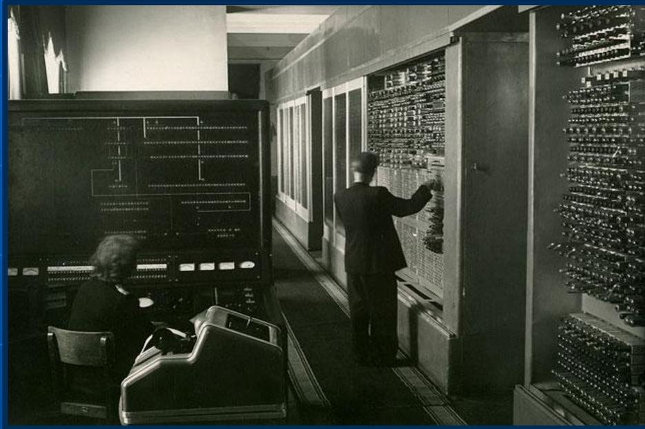
**БЭСМ** - выполняла программы со скоростью примерно 10 000 команд в секунду. Память БЭСМ состояла из 1024 ячеек (по 39 разрядов). Эта память была построена на магнитных сердечниках. Внешняя память ЭВМ была размещена на двух магнитных барабанах и одной магнитной ленте и вмещала 100 000 39-битных слов.
