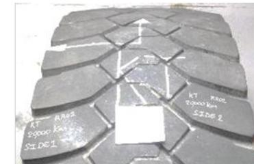
Поперечные канавки в центре протектора
