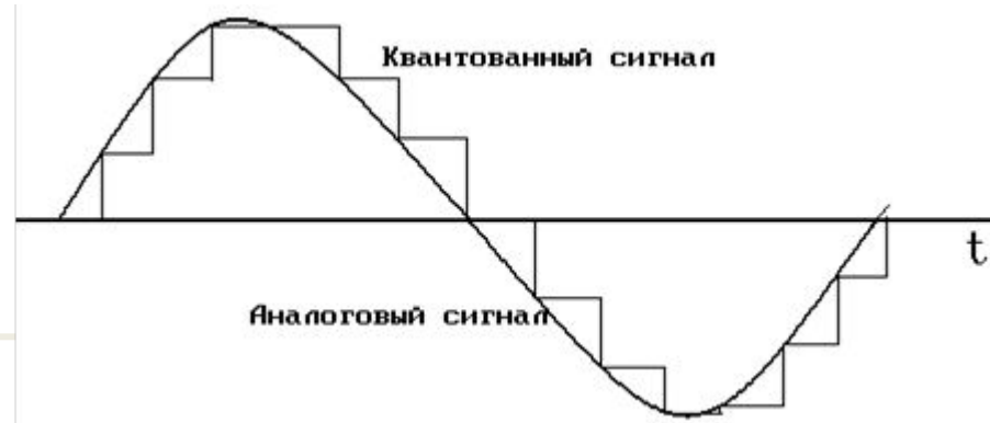
Рис. Квантование электрического сигнала синусоидальной формы
