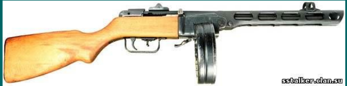
7,62-ММ ПИСТОЛЕТ-ПУЛЕМЕТ ДЕГТЯРЕВА ОБР. 1940 Г. (ППД-40)
