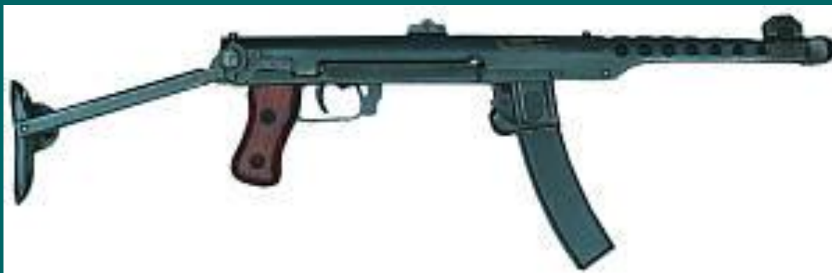
7,62-ММ ПИСТОЛЕТ-ПУЛЕМЕТ СУДАЕВА ОБР. 1943 Г. (ППС)
