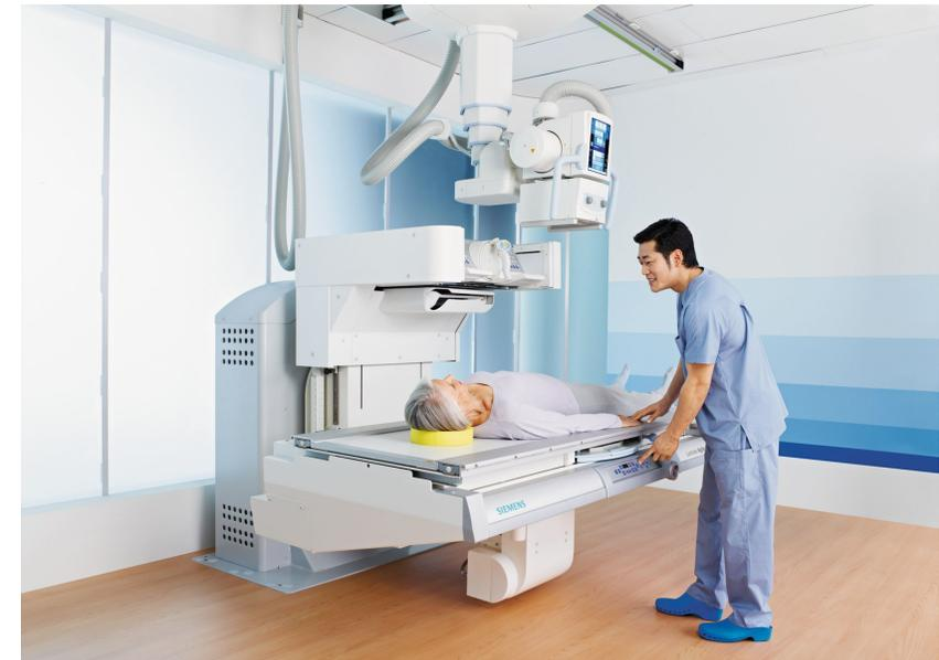
В качестве усовершенствованного метода рентгеноскопии применяют рентгентелевизионное просвечивание с помощью усилителя рентгеновского изображения – электронно-оптического преобразователя (ЭОП) и замкнутой телевизионной системы. В ЭОП видимое изображение на флюоресцирующем экране усиливается, преобразуется в электрический сигнал и отображается на экране дисплея.
