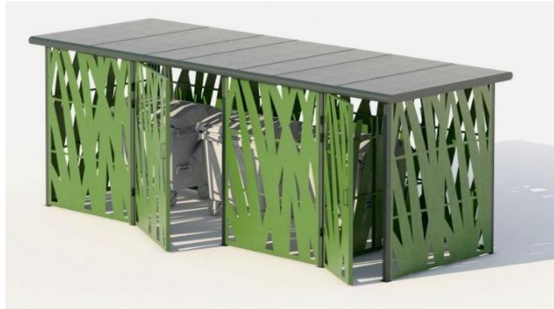
В формообразовании дизайн-проекта контейнерной площадки присутствуют исключительно прямые линии. Решётчатая часть конструкции изготовлена по бионическому образу растительности. Аналогичный проект изготовлен из металлокаркаса и листовой стали.
