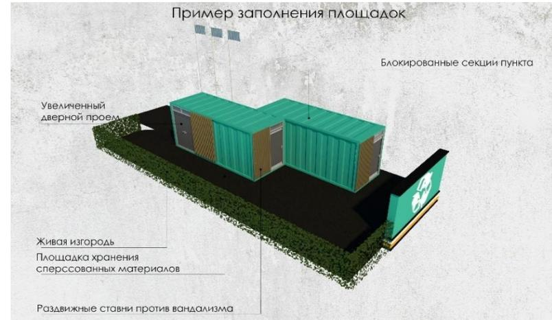
Аналогичный дизайн-проект разработан на основе 20-тонного грузового контейнера. Крупногабаритная многооборотная тара выполняет функцию каркаса и стен.
