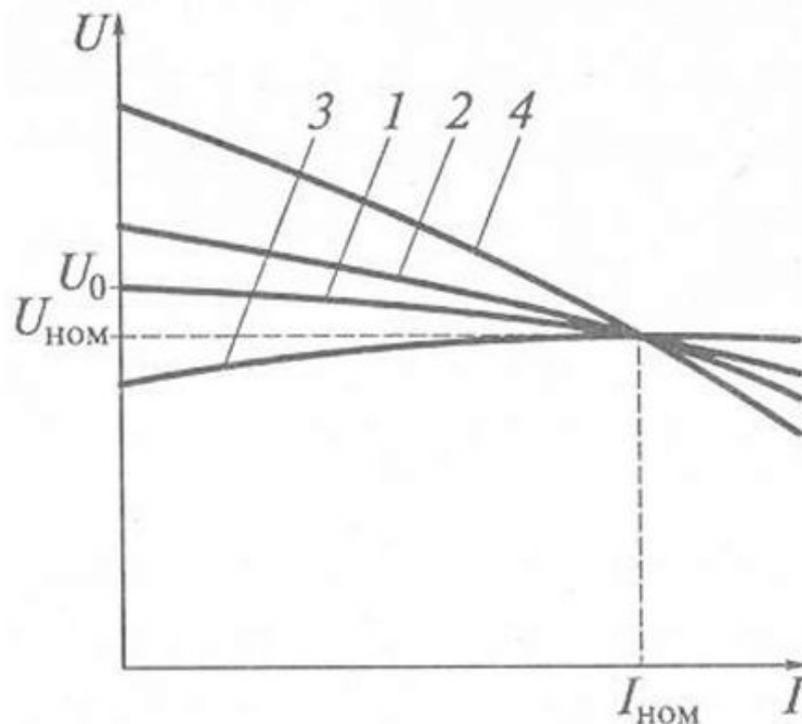
Внешние характеристики генератора постоянного тока с независимым (1), параллельным (2), смешанным согласным (3) и смешанным встречным (4) возбуждением
