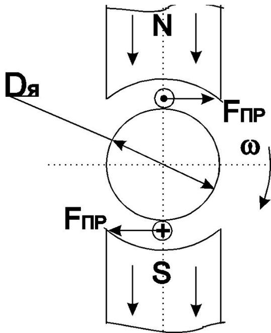
Парой полюсов создаётся основной магнитный поток машины.
