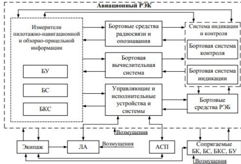
Рис. 1. Обобщенная структурная схема авиационного РЭК
