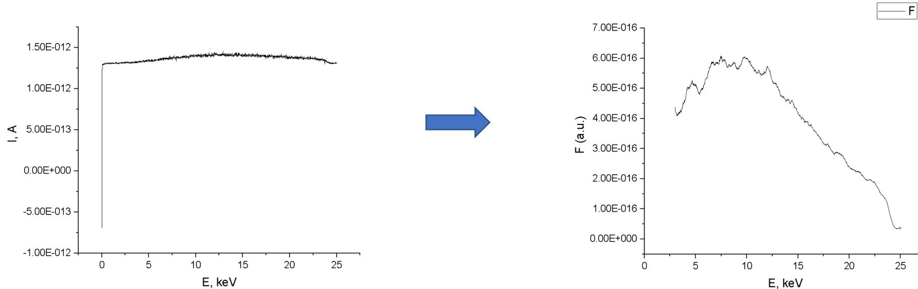
При анализе экспериментальных результатов иногда требуется обработать такое количество данных, что без автоматизации действий не обойтись. В качестве примера результатов возьмем энергетические спектры рассеянных протонов от кремниевой подложки в процессе напыления на неё золота на установке «Крокодил». В этом может помочь встроенный в Ориджин язык программирования Labtalk.
