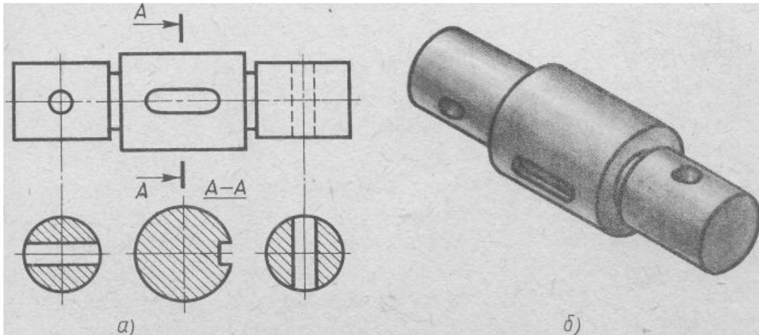
**Сечение** — это изображение фигуры, получающейся при мысленном рассечении предмета плоскостью. На сечении показывают только то, что находится непосредственно в секущей плоскости.
