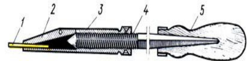
Рис. 312. Шабер со сменными режущими пластинками
