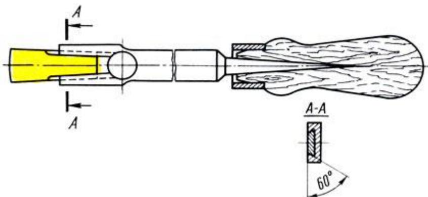
Рис. 313. Шабер усовершенствованный
