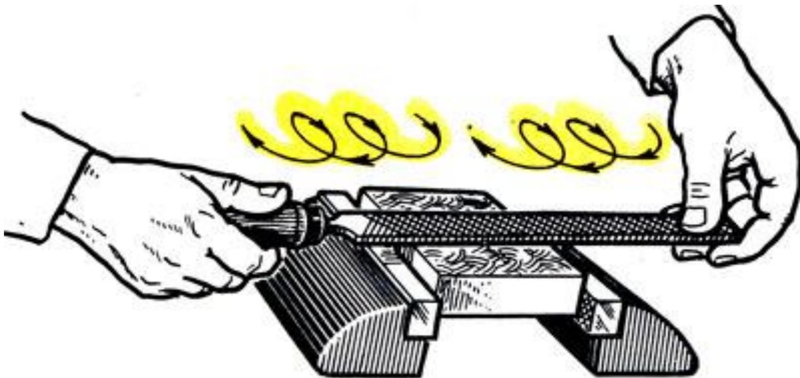
*Рис. 306. Припиливание поверхности с проверкой 'на краску'*
