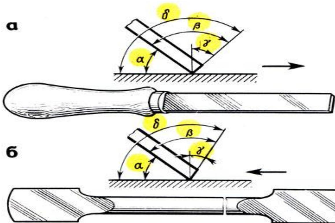
Рис. 307. Плоские односторонний (а) и двусторонний (б) шаберы и углы заточки
