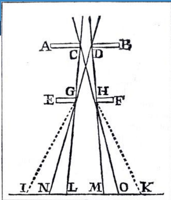
Опыт Гримальди по дифракции(1665) Свет, входящий через отверстие CD в окне и проходящий отверстие GH в непрозрачной стенке, образует на экране световое пятно LM, окруженное цветными кольцами
