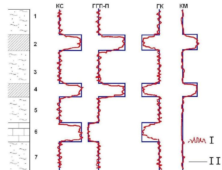
Выделение угольных пластов комплексом методов.
