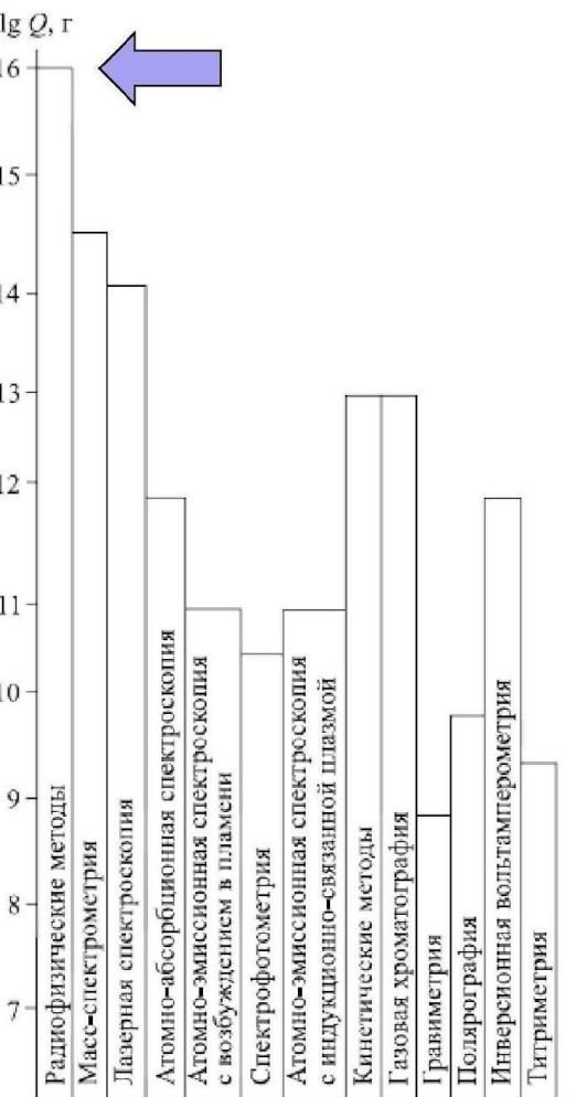
Нижние границы определяемых содержаний компонентов ( $-\lg Q, \text{ г}$ ) для некоторых методов анализа
