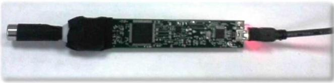
Через разъем USB локатор подключается к компьютеру. Специальное программное обеспечение позволяет осуществить индикацию результата, регулировку напряжения и порогов дискриминации.
