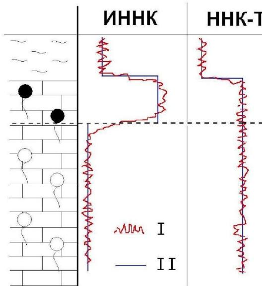
**ННК-Т** — нейтрон-нейтронный каротаж по тепловым нейтронам – измеряют изменение плотности потока тепловых нейтронов
