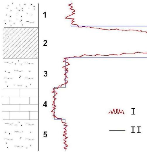
**ГГК-П** (плотностной гамма-каротаж) - показания характеризуются в основном по Комптоновскому эффекту, применяют на нефтяных и газовых месторождениях:
