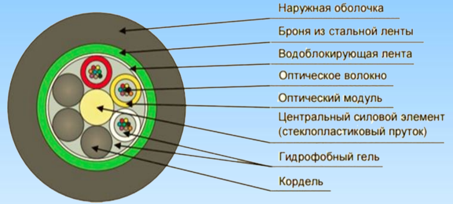
Рисунок 5(3.2) -Кабель в разрезе ДОЛ-П-64У (2x8)(4x12)-2,7 кН
