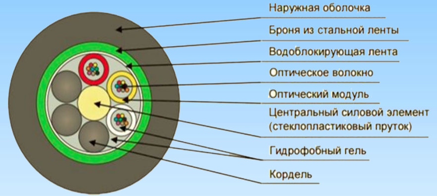
Рисунок 5(3.2) -Кабель в разрезе ДОЛ-П-64У (2x8)(4x12)-2,7 кН
