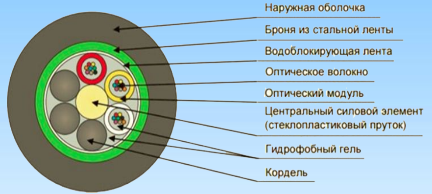
Рисунок 5(3.2) -Кабель в разрезе ДОЛ-П-64У (2x8)(4x12)-2,7 кН
