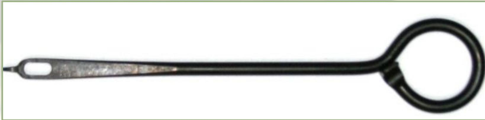
***Протирка имеет: на одном конце - выступ для снятия и постановки крючка пружины шептала и для утапливания гнетка при отделении выбрасывателя; прорезь для продевания в нее пакли или ветоши; на другом - кольцо для удержания протирки при чистке. На стыке кольца имеется лезвие для вывинчивания и ввинчивания винта рукоятки при разборке и сборке пистолета.***
