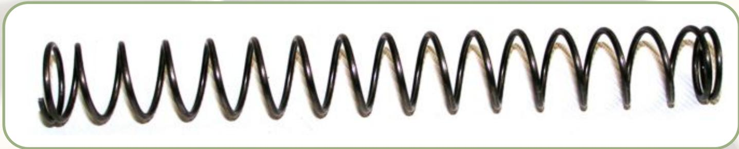
*служит для возвращения затвора в переднее положение после выстрела. Крайний виток одного из концов пружины имеет меньший диаметр по сравнению с другими витками. Этим витком пружина при сборке надевается на ствол, чтобы обеспечить ее надежное удержание на стволе при разборке пистолета.*
