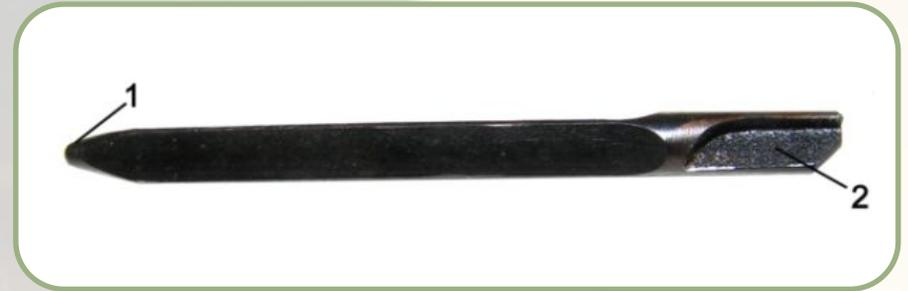
**2.2.Выбрасыватель** служит для удержания гильзы в чашечке затвора до встречи с отражателем.
