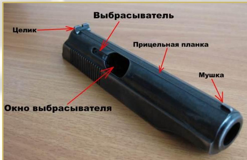
*Затвор служит для подачи патрона из магазина в патронник, запираания канала ствола при выстреле, удержании гильзы (извлечение патрона) и постановки курка на боевой взвод.*
