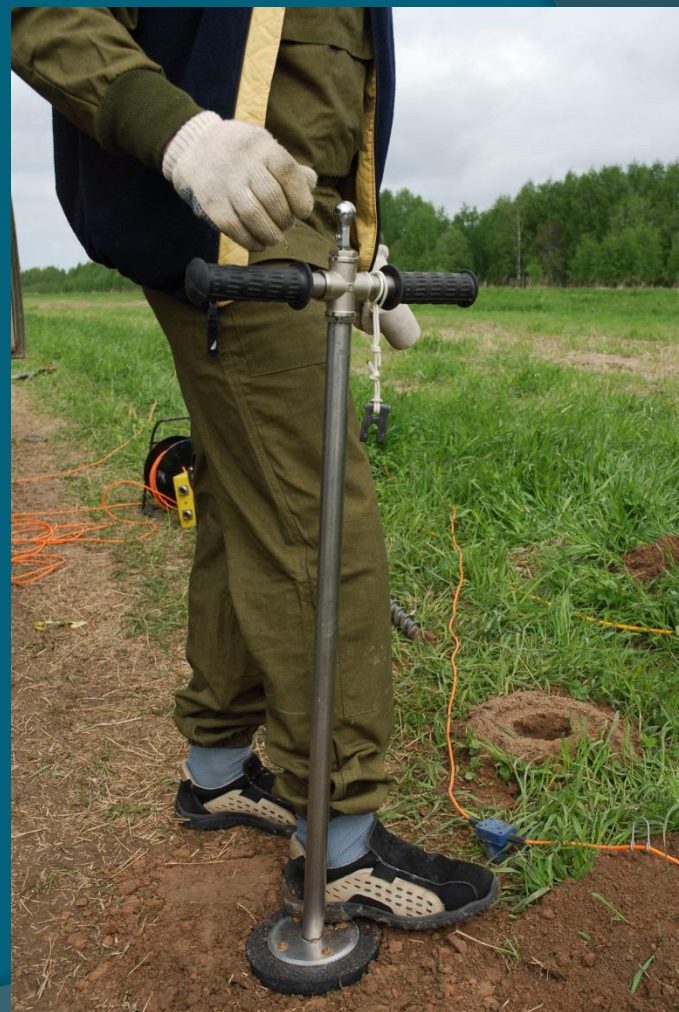
Импульсный пороховой источник (ГИ УрО РАН)
