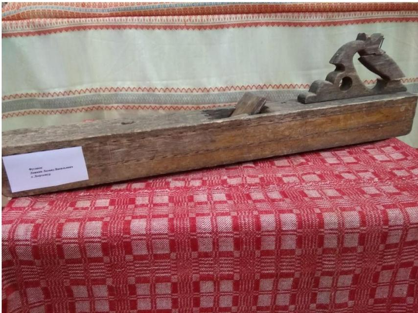
▣ Рубанок— ручной деревообрабатывающий инструмент для строгания. Рубанки используются для придания поверхностям **деревянных** деталей нужной шероховатости, прямолинейности, плоскостности, формы, уменьшения размеров деталей, а также для создания в деталях протяжённых выемок различной формы («четвертей», «шпунтов» и пр.).
