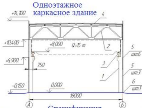
Спецификация сборных железобетонных конструкций
