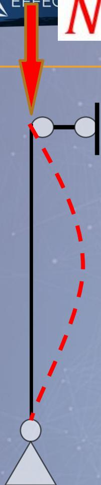
Для железобетона рассматривается только потеря устойчивости по неупругой схеме по следующим причинам
