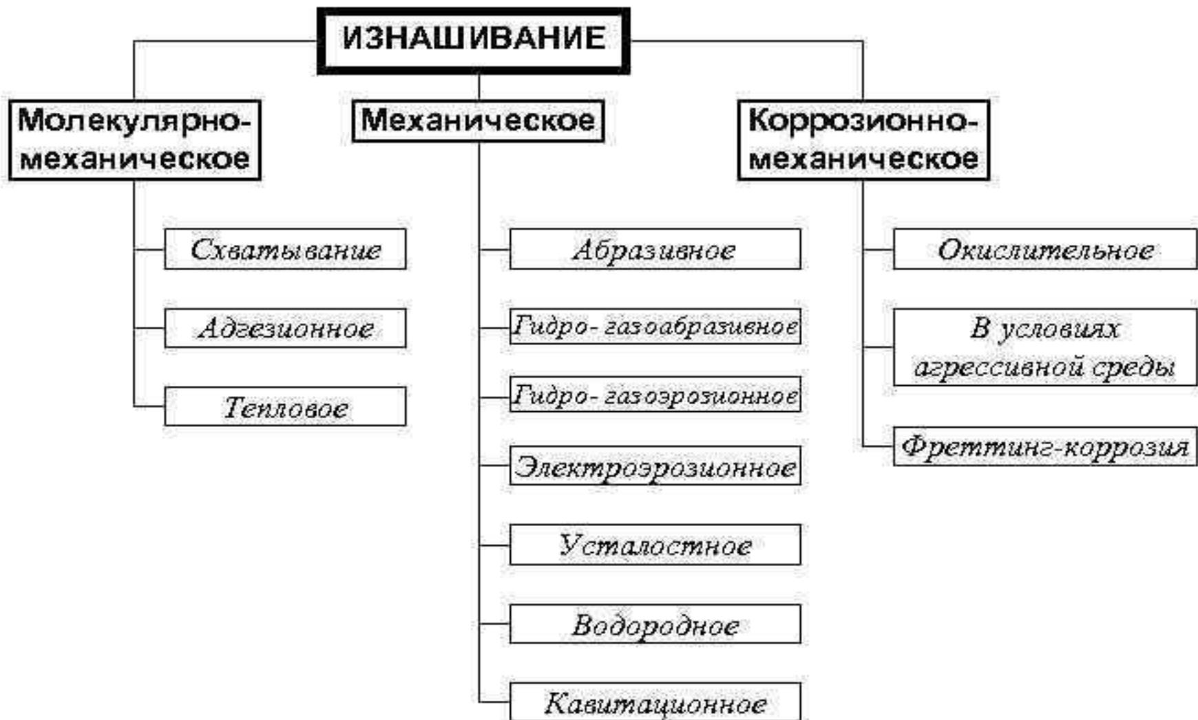
**Молекулярно-механическое изнашивание** вызывается одновременным воздействием молекулярных и механических сил. Его характерными признаками являются схватывания, задиры, а также перенос частиц металла с одной из сопрягаемых поверхностей на другую.
