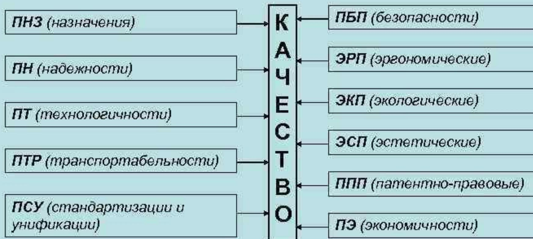
**ПНЗ (показатели назначения)** - характеризуют свойства объекта, определяющие основные функции, для выполнения которых он предназначен (производительность, мощность, к.л.д. и др.)
