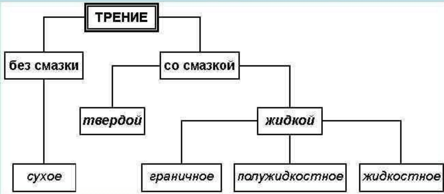
Для **сухого** трения (трения без смазочного материала) характерно механическое зацепление микронеровностей и молекулярное взаимодействие поверхностей в зоне контакта.
