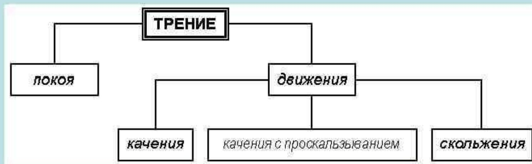
Для трения скольжения характерно *истирание* деталей, а для трения качения - *смятие* и *выкрашивание*. Для деталей работающих в условиях сложного трения, при котором происходит перекатывание со сдвигом (зубчатые передачи), характерно выкрашивание (*гипотинг*).
