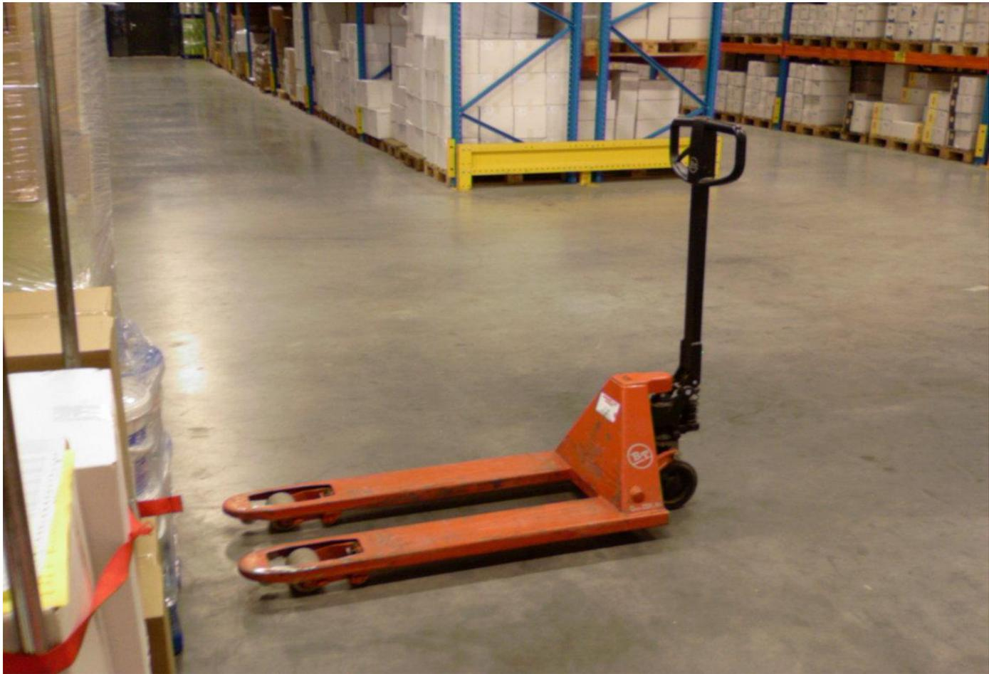
Рисунок Гидравлическая тележка ТГВ 500М
