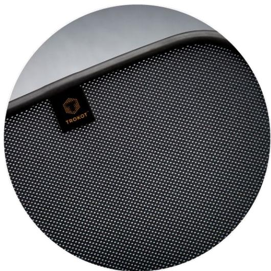
**РЕЗИНОВЫЙ ОКАНТОВОЧНЫЙ ПРОФИЛЬ (ПОЛИМЕР)** обеспечивает более плотную вставку в оконном проёме и защищает панель двери от протирания, а также от дребезжания шторок во время езды. Профиль устойчив к перепадам температуры, не выгорает на солнце и не трескается в мороз.
