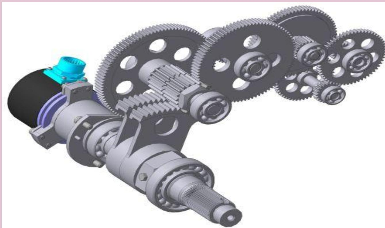
Для приведения в движение машины ей передается механическая энергия от двигателя. В большинстве случаев двигатели и исполнительные органы рабочей машины связываются не непосредственно, а с помощью механизмов, называемых **передачами**, которые бывают механические, гидравлические, пневматические и электрические. В дальнейшем будем рассматривать только механическими передачами.
