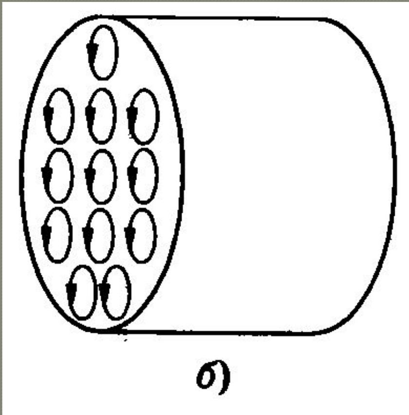
Б) В намагниченном состоянии элементарные токи в теле ориентированы строго определенным образом, так что их действия складываются
