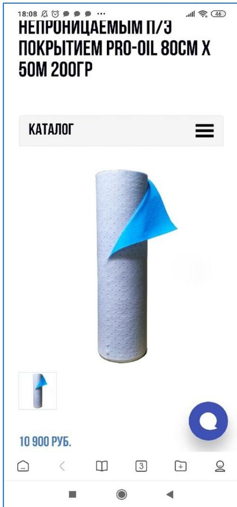
Мы же планируем выплёскивать из катамарана адсорбенты, а также параллельно установить систему очистки адсорбированным полотном. Одно полотно способно впитать до 144 л нефтепродуктов
