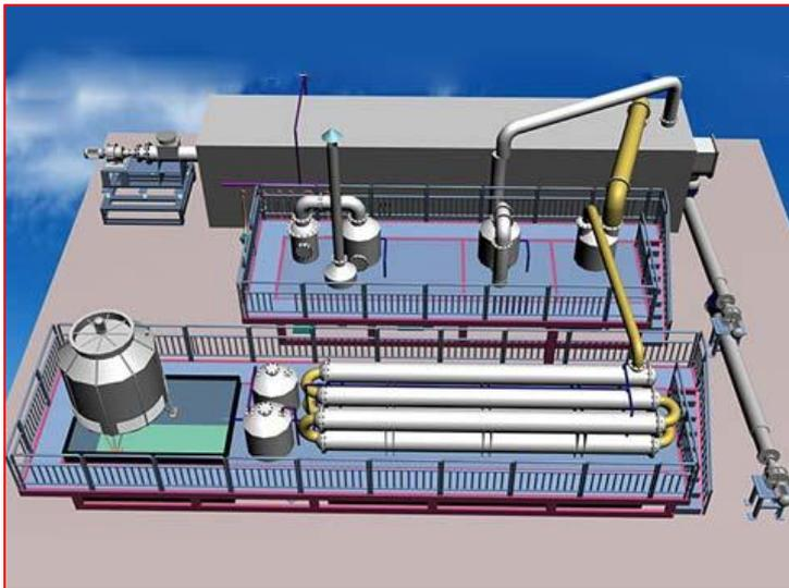
Пиролиз отходов заключается в том, что под воздействием высоких температур в условиях вакуума разлагаются тяжелые органические вещества, на выходе получают более легкие. В результате такого воздействия из отходов получают вещества с более низкой молекулярной массой.
