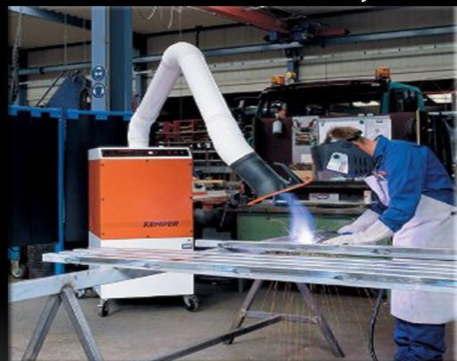
ВЫТЯЖКА СВАРОЧНЫХ ДЫМОВ
