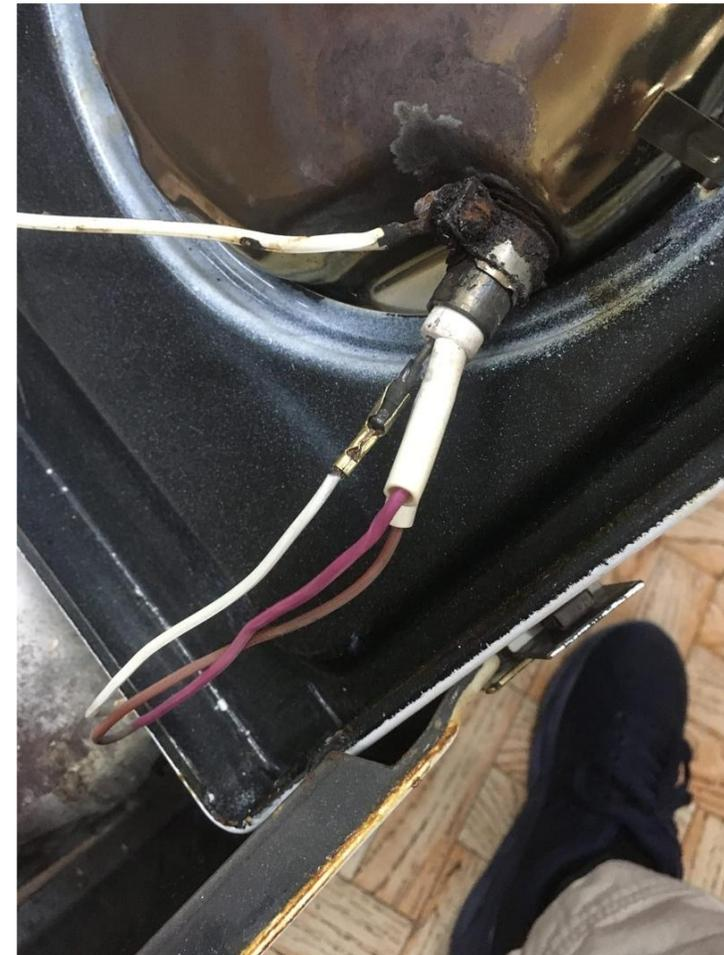
Причина не работающей электрокомфорки был оторванный провод. Устраняем поломку.
