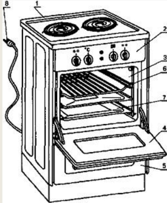
1 — плита с электроконфорками; 2 — панель управления; 3 — электрошкаф жарочный; 4 - дверца электрошкафа жарочного; 5 - шкаф выдвижной или отсек; 6 - решётка; 7 - противень; 8 - шнур соединительный.
