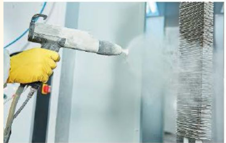
Рис. 2.8. Процесс порошкового напыления
