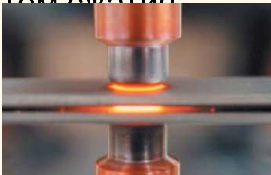
Рис. 2.11. Процесс контактной электросварки
