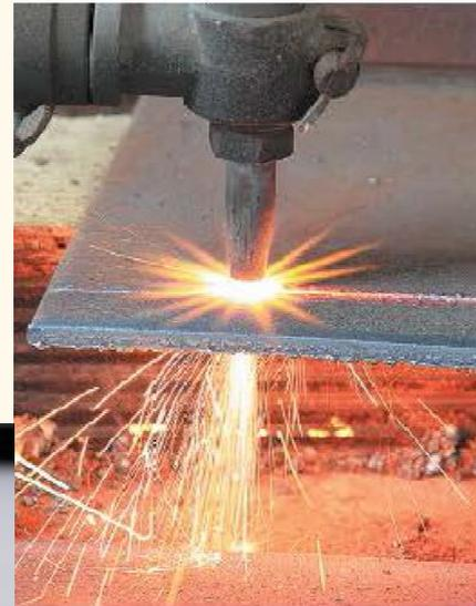
Рис. 2.1. Газовая резка металла
