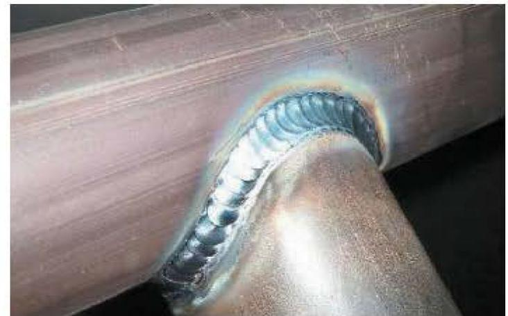
*Рис. 2.10. Соединение труб электродуговой сваркой*
