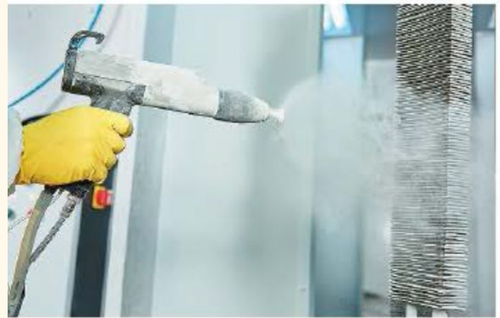
Рис. 2.8. Процесс порошкового напыления
