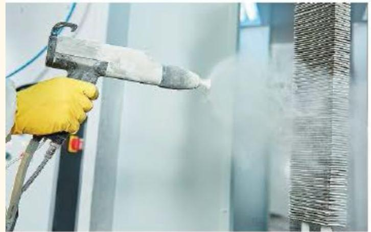
*Рис. 2.8.* Процесс порошкового напыления
