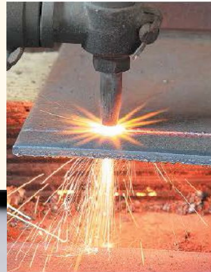
Рис. 2.1. Газовая резка металла
