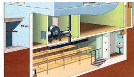
**Противорадиационное укрытие** — защитное сооружение гражданской обороны, предназначенное для защиты укрываемых от воздействия ионизирующих излучений при радиоактивном заражении (загрязнении) местности и допускающее непрерывное пребывание в нем укрываемых в течение нормативного времени.
