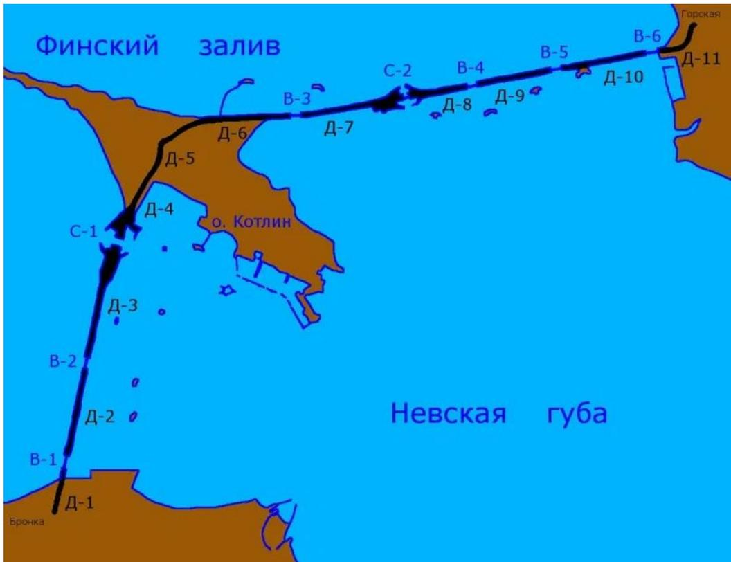
Дамба защищает Санкт-Петербург и Кронштадт от стонно-нагонных явлений при подъёме воды до 4,2 метра выше ординара. Общая длина сооружения составляет 25,4 километра, из которых 22,2 километра проходит по акватории. Высота дамбы составляет 6,4 метра над средним многолетним уровнем воды, верхняя отметка волноотбойной стенки — 7,5 метров. Комплекс состоит из 11 защитных дамб.
