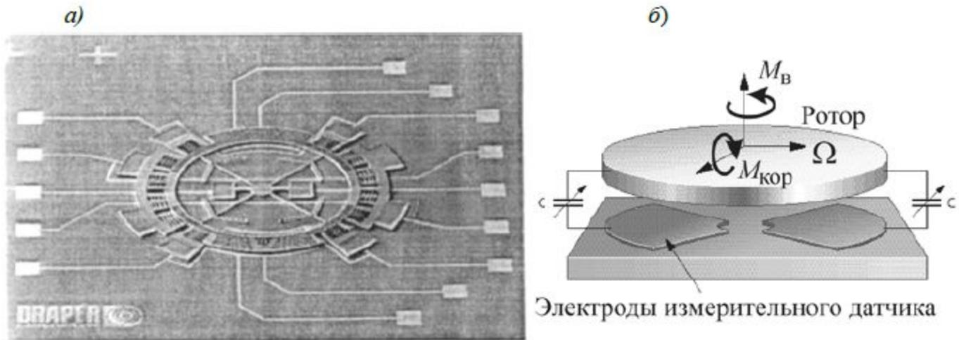
Гироскоп в виде диска *Draper Laboratory* (США):
