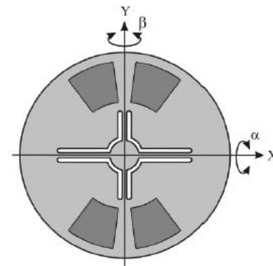
Базовые расчетные схемы ММГ RR – типа:
