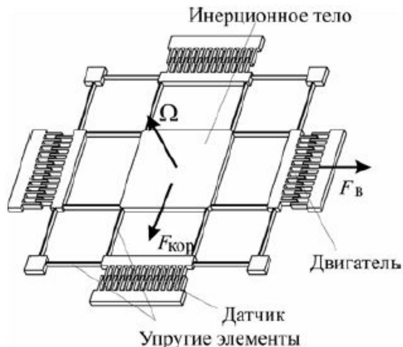
Конструкции с осью чувствительности, перпендикулярной плоскости гироскопа:
