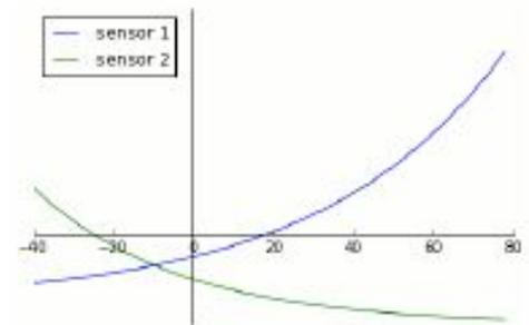
Причём для каждого датчика такая зависимость может быть уникальной (нет общей модели для датчиков данного вида).
