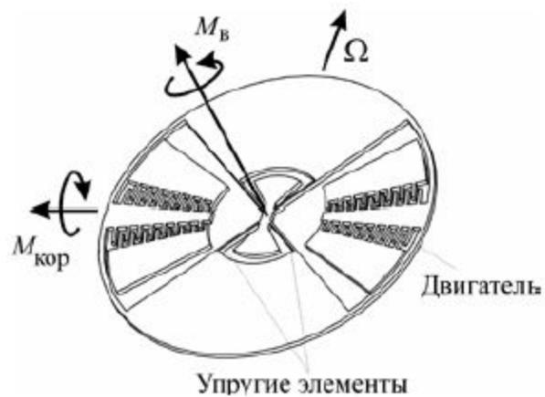
Конструкции отечественных одномерных ММГ:
