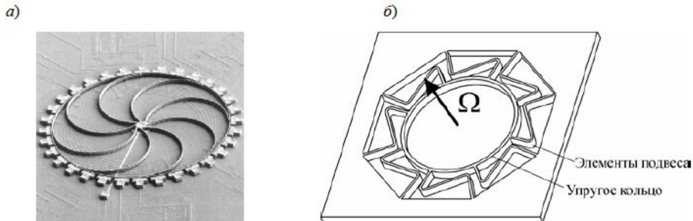
Рис. 14. Конструкции с упругим кольцом:
