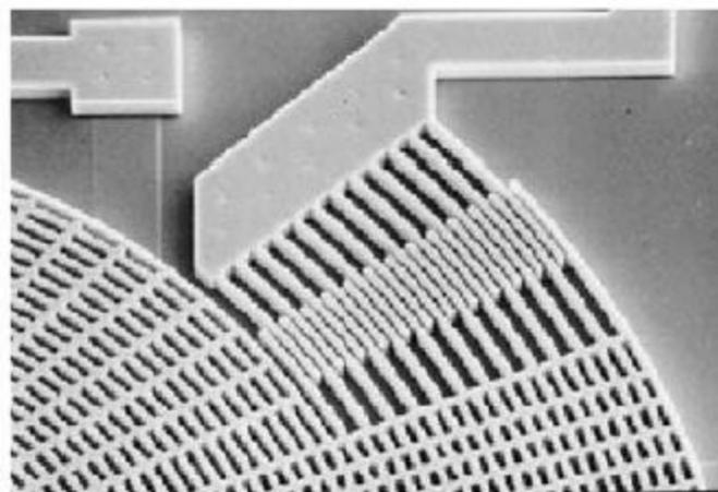
Разработка гироскопа фирмы *Bosch GmbH* (Германия):
