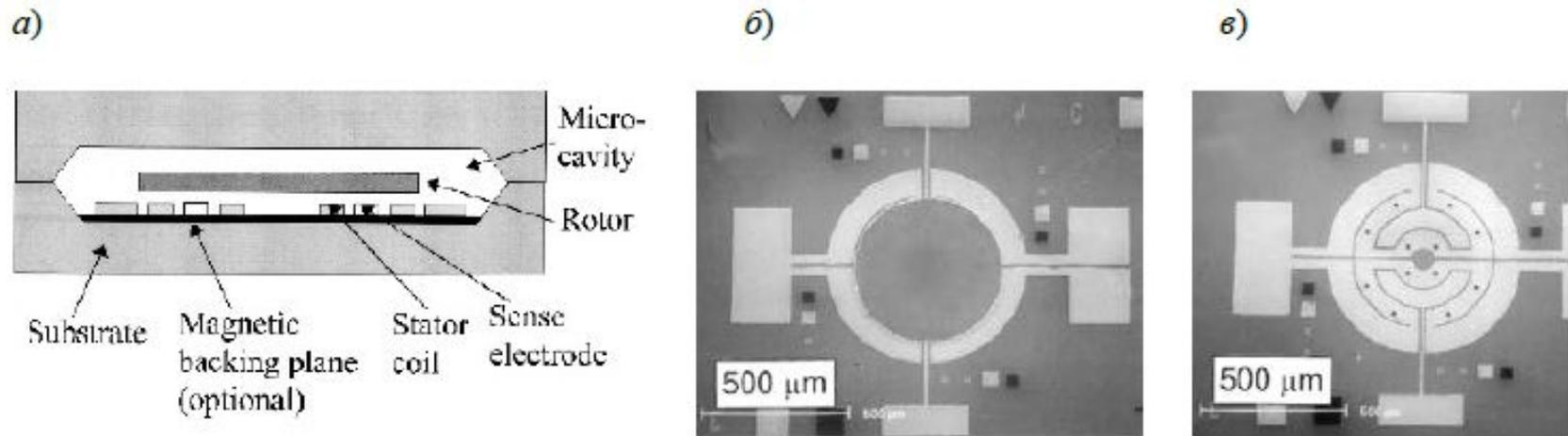
Рис. 15. ММГ с бесконтактным подвесом ротора:
