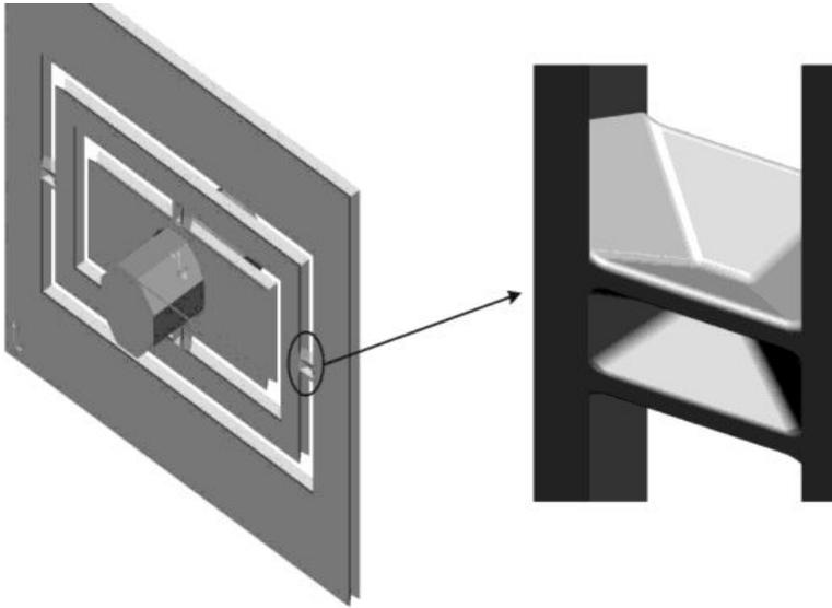
**Достоинства:** высокая добротность колебательного контура и высокая жесткость по паразитным степеням свободы, высокая чувствительность.
