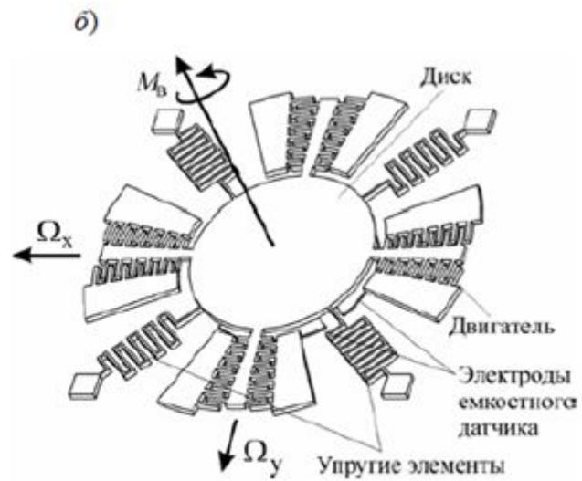
Конструкции двумерных ММГ с наружным подвесом:
