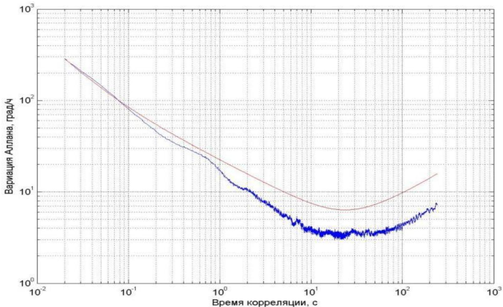
Вариация Аллана типового ДУС серии ММГК (микромеханический волновой гироскоп кольцевого типа).
