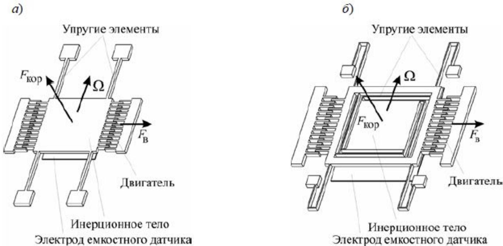
Конструкции стержневых подвесов с поступательными движениями:
