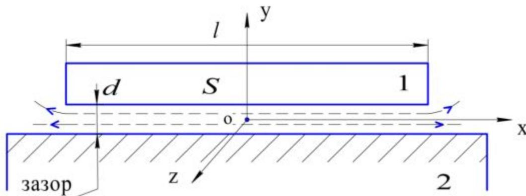
Структурная схема газового течения в тонком зазоре МЭМС
