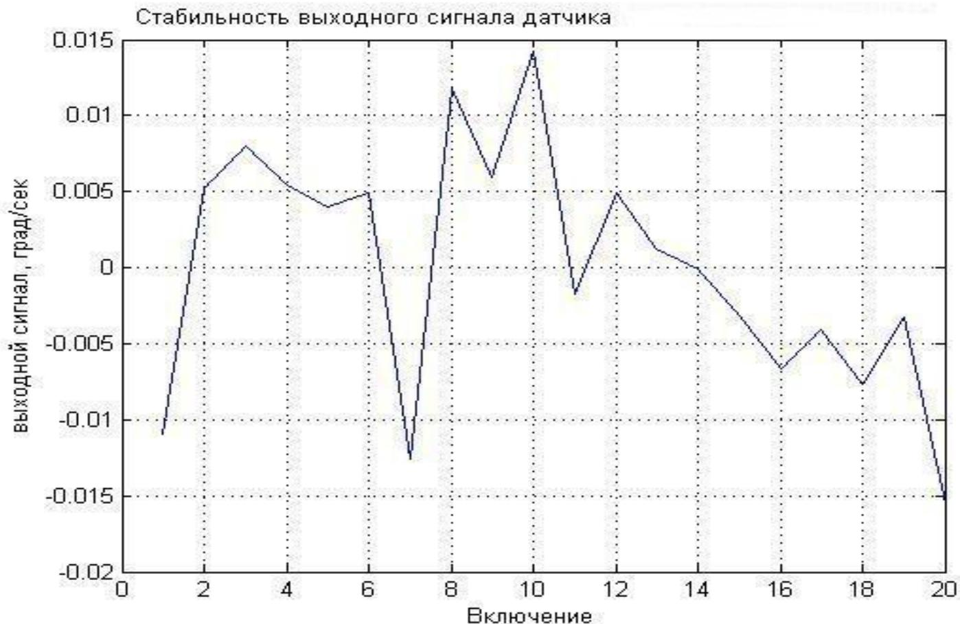
Стабильность нулевого сигнала гироскопа от включения к включению.
