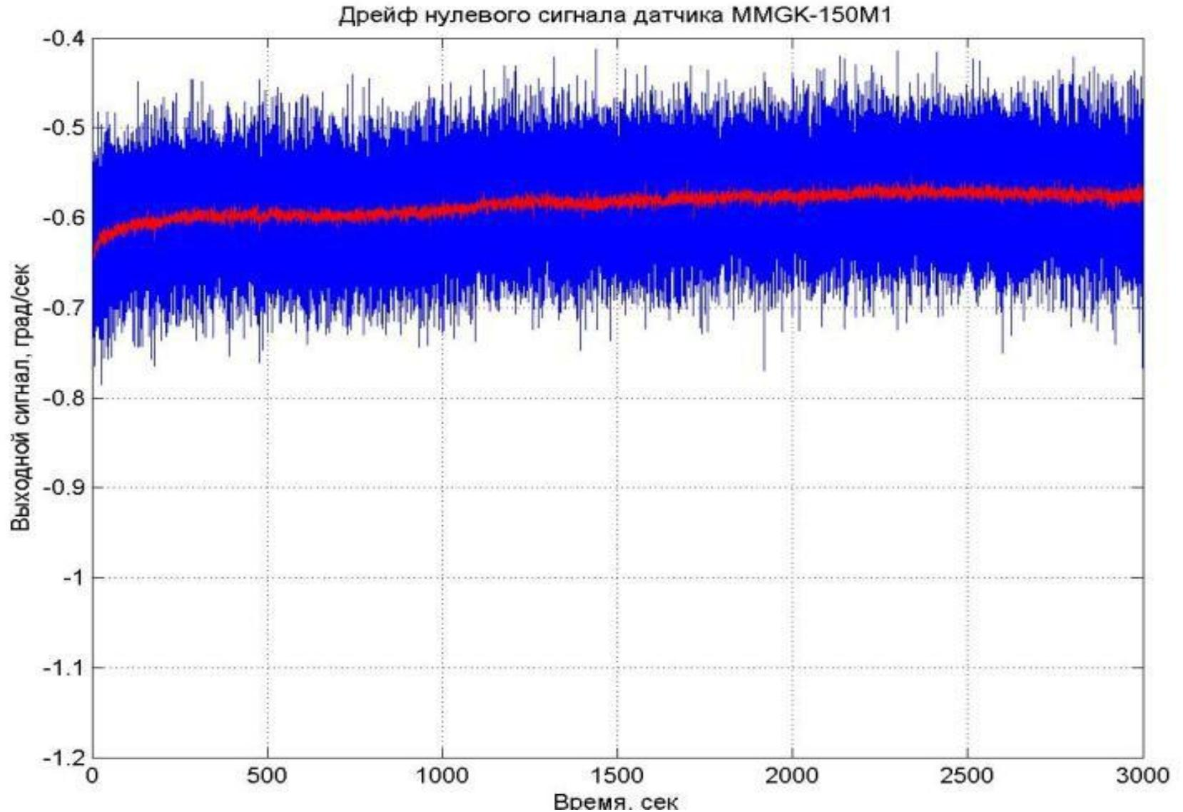
Случайная составляющая нулевого сигнала (в полосе 1Гц)
