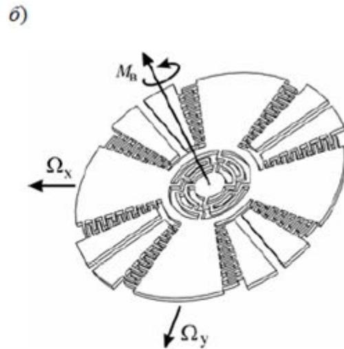
Конструкции двумерных ММГ с внутренним подвесом:
