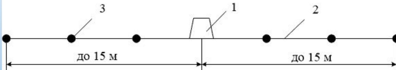
1 – стойка опоры; 2 – горизонтальный заземлитель; 3 – вертикальный заземлитель
