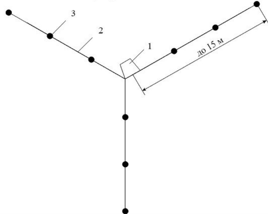
1 – стойка опоры; 2 – горизонтальный заземлитель; 3 – вертикальный заземлитель
