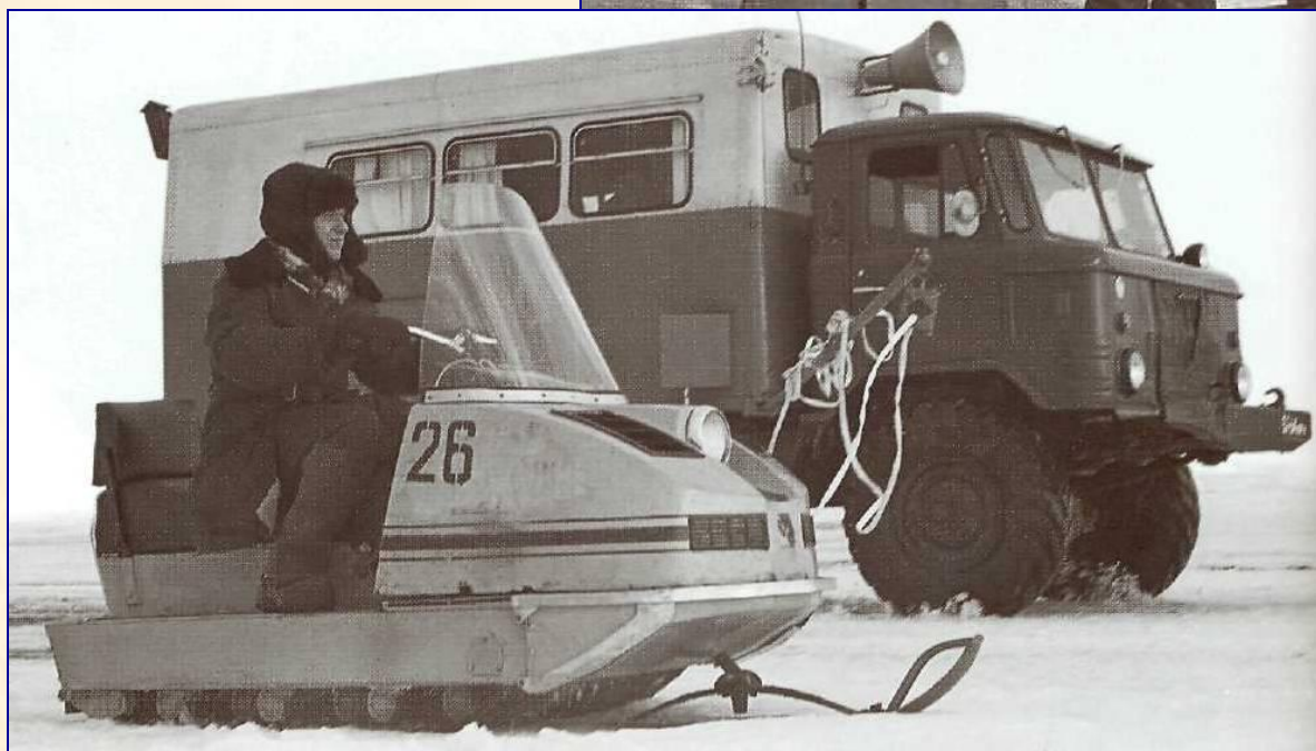
Испытание снегоходов. Машина-лаборатория, регистрирующая работу «Бурана». 1979г.
