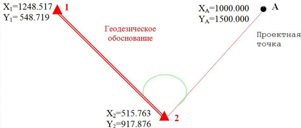
Схема вычисления проектного угла
