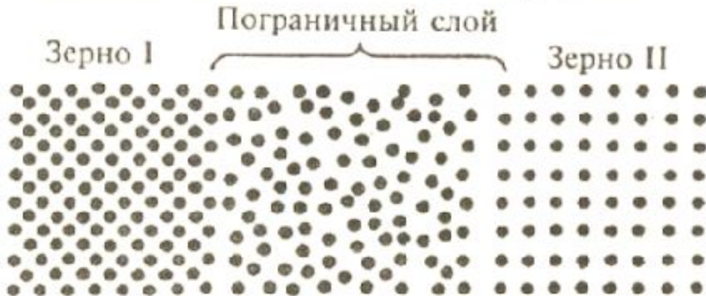
Рис. 11. Модель размещения атомов в объеме и на границе зерна
