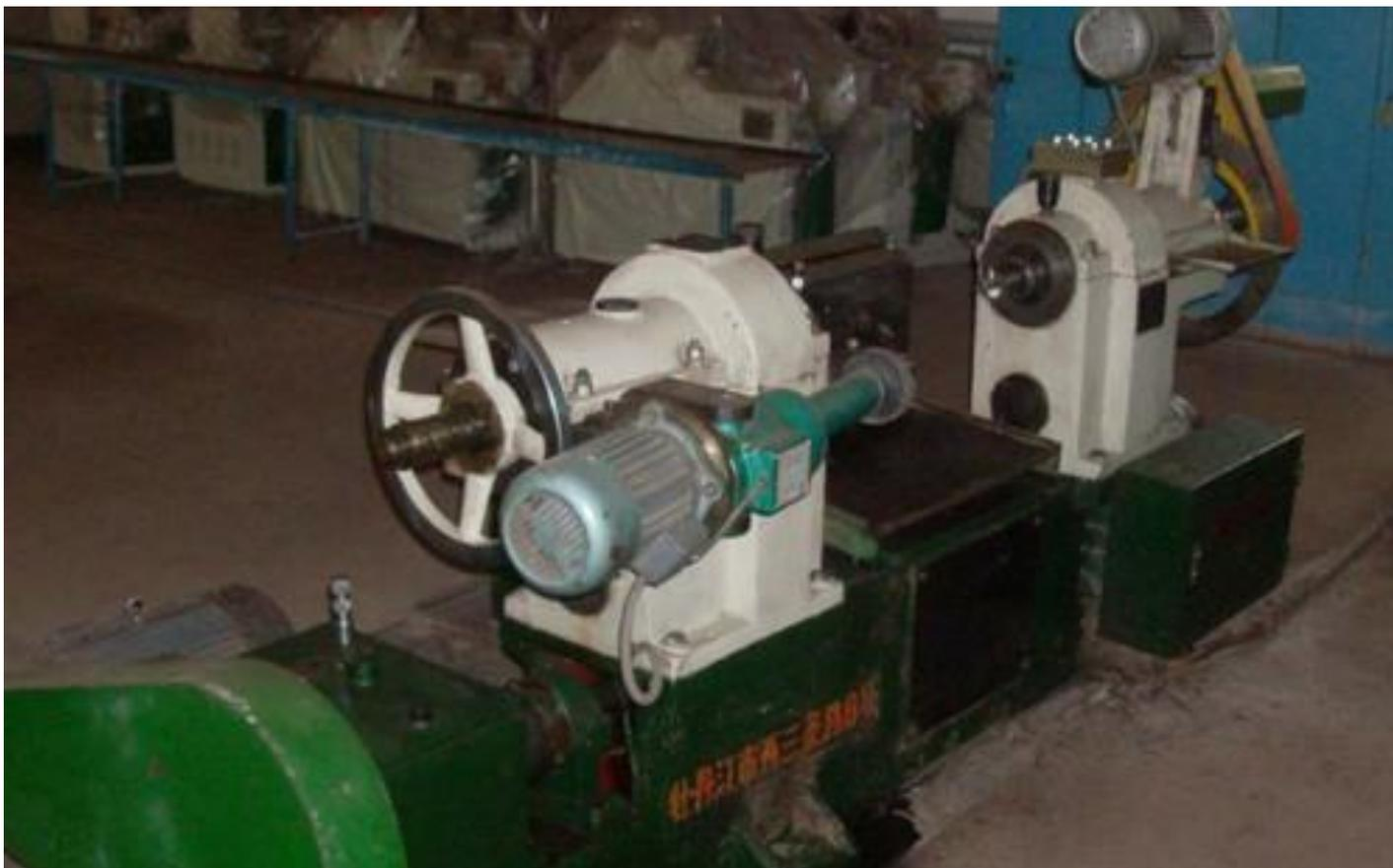
Станок лущильный ширина ножа 470 мм, толщина шпона от 0,5 до 6,5мм., возможно заменить лущильный нож до 620 мм
