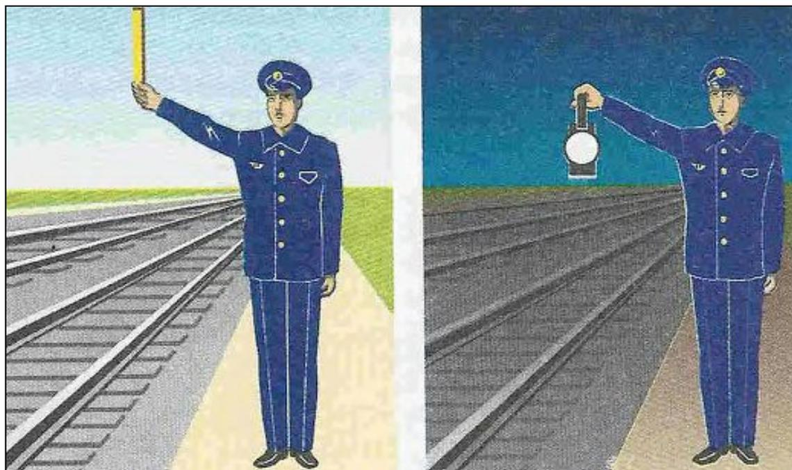
**При опробовании автотормозов** требование машинисту произвести пробное торможение подается: днем – **поднятой вертикально рукой**, ночью – поднятым ручным фонарем с прозрачно-белым огнем. Машинист отвечает **одним коротким свистком** и приступает к торможению.
