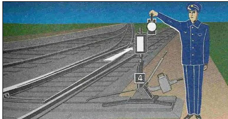
В случае приема поезда **на боковой путь** или с **остановкой** на станции они подают сигнал: днем – **развернутым желтым флагом**; ночью – **желтым огнем** ручного фонаря.
