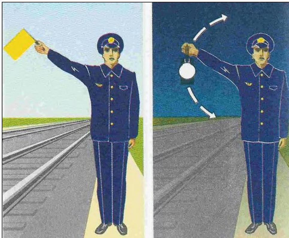
**При свободности пути** и отсутствии препятствия для движения подается сигнал днем – **свернутым желтым** флагом, ночью – **прозрачно-белым** огнем ручного фонаря.
