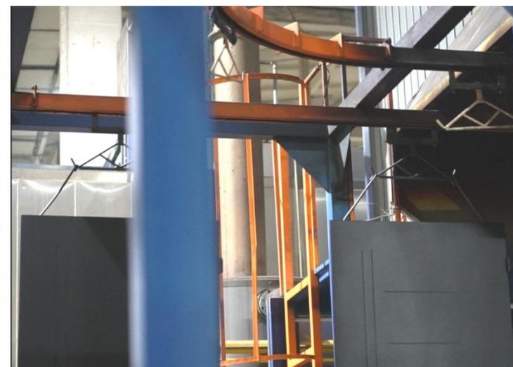
Полный цикл производства МДФ/панелей, в том числе и сборных – царговых. В данный этап входит раскрой МДФ, фрезеровка, покрытие пленкой и шпоном, патинирование и нанесение лака.
