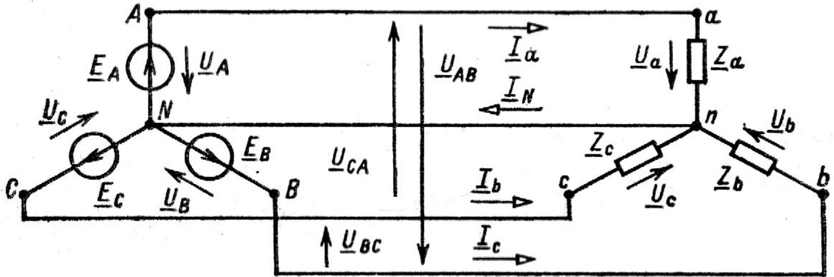
Нейтральные точки может соединять **нейтральный** провод N-n. В данном случае цепь будет четырехпроводной. При отсутствии данного соединительного провода, между нейтралью можно измерить напряжение смещения нейтрали  $U_{Nn}$ . При этом цепь будет трехпроводной. За условное положительное направление фазных напряжений принимают направление от начала к концу фаз обмоток, а линейных напряжений – от начала одной фазы к началу другой.
