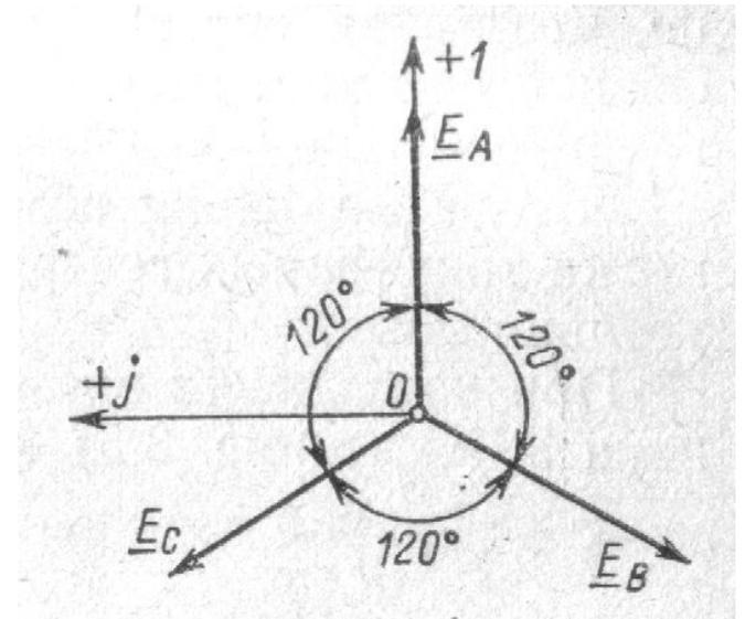
Систему ЭДС в которой ЭДС фазы С отстает от ЭДС фазы В, а в свою очередь ЭДС фазы В отстает от ЭДС фазы А, называют системой **прямой** последовательности (рис. а). Если изменить направление вращения ротора генератора, то последовательность фаз измениться и ее называют системой **обратной** последовательности (рис. б). На практике применяется прямая последовательность фаз, т.е. А – В – С.
