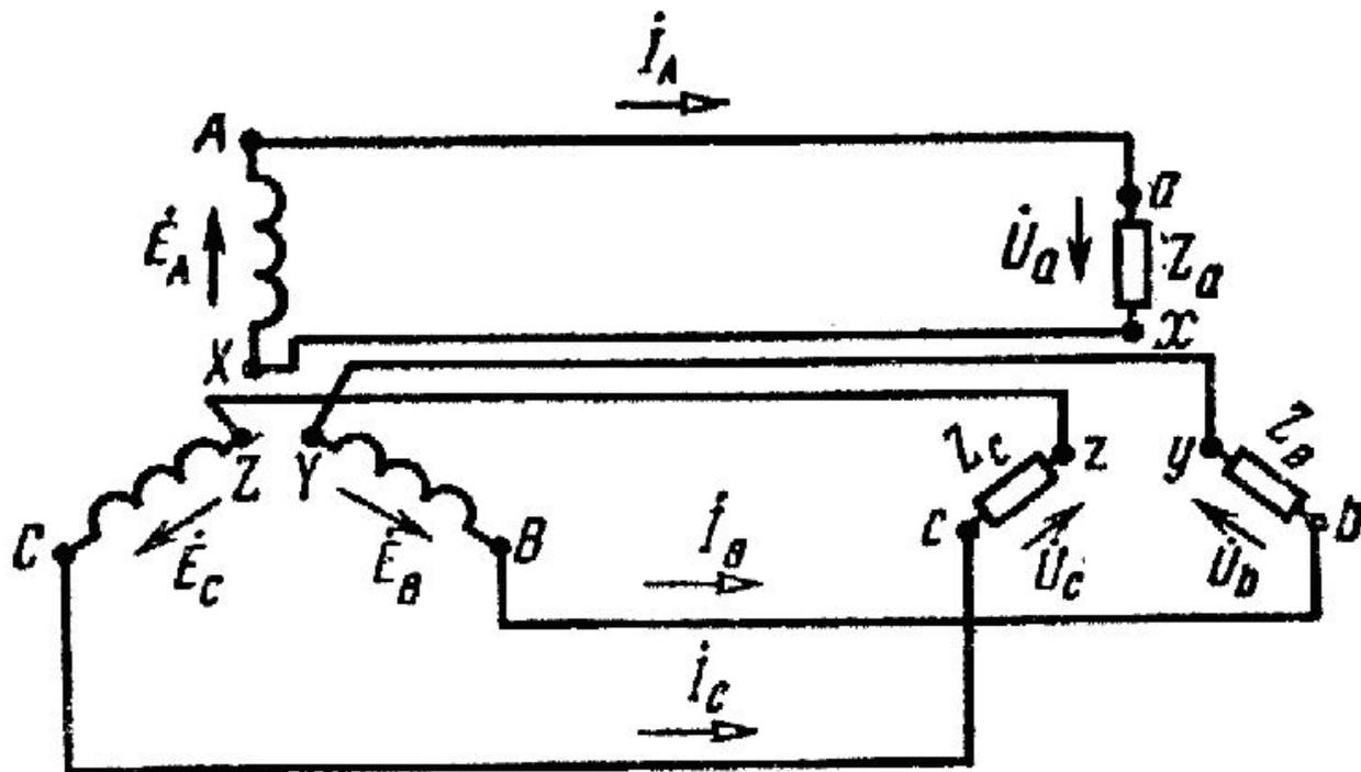
Более совершенными и экономичными являются **связанные** цепи, в которых фазы обмоток соединены между собой. Основные схемы соединения трехфазных цепей: соединение **звездой** (а) и **треугольником** (б), разработанные и внедренные в практику М.О. Доливо-Добровольским в начале 90-х годов 19 века.
