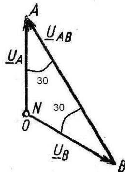
т.е. линейное напряжение при соединении обмоток генератора звездой в  $\sqrt{3}$  раз больше фазного. С учетом данного соотношения построена шкала стандартных напряжений трехфазных генераторов: 220\127, 380\220 и 660\380 при напряжении до 1000 Вольт.
