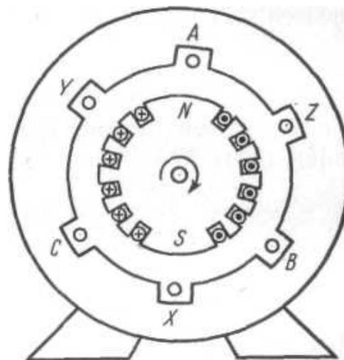
На схемах обмотку (или фазу) источника переменного ЭДС обозначают как показано ниже. За условное положительное направление ЭДС в каждой фазе принимают направление от конца к началу.
