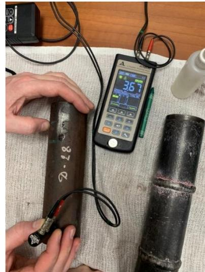
Ультразвуковая толщинометрия на отрезке экранной трубы котла (ГОСТ Р ИСО 16809-2015)
