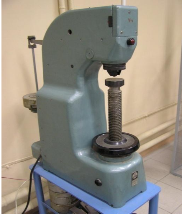
Твердомер Бринелля ТШ-2М
