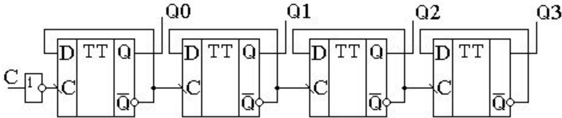
По этой диаграмме видно, что при поступлении на вход счётчика первого же импульса на выходах появляется максимально возможное для четырёхразрядного счётчика число  $15_{10}$ . При поступлении следующих импульсов содержимое счётчика уменьшается на единицу.
