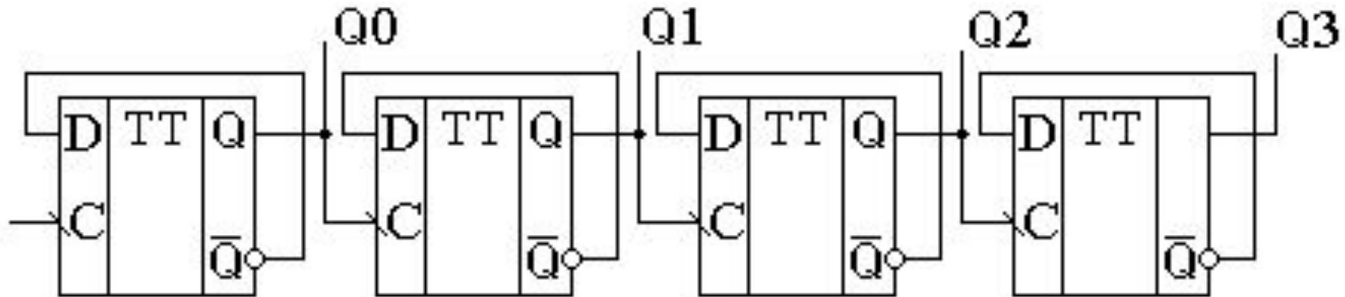
Для того чтобы разобраться, как работает схема двоичного счётчика, воспользуемся временными диаграммами сигналов на входе и выходах этой схемы:
