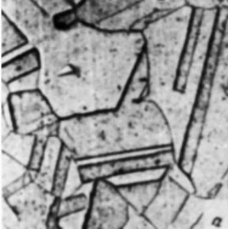
Микроструктура железа, \times 400 : аустенит
