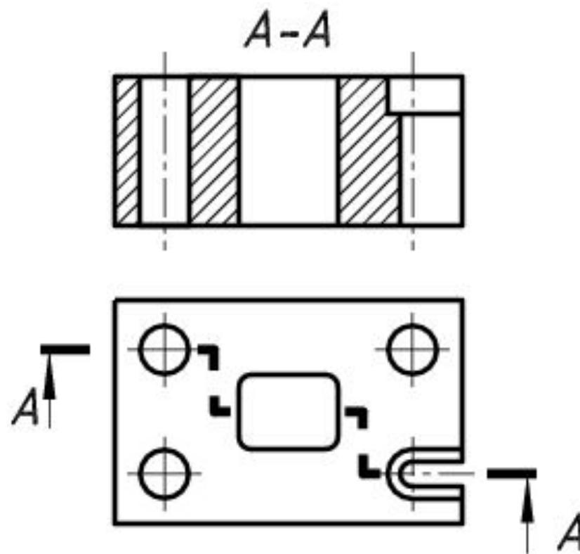
**Разрез ломаный** так называют разрез сложный, если секущие плоскости пересекаются.
