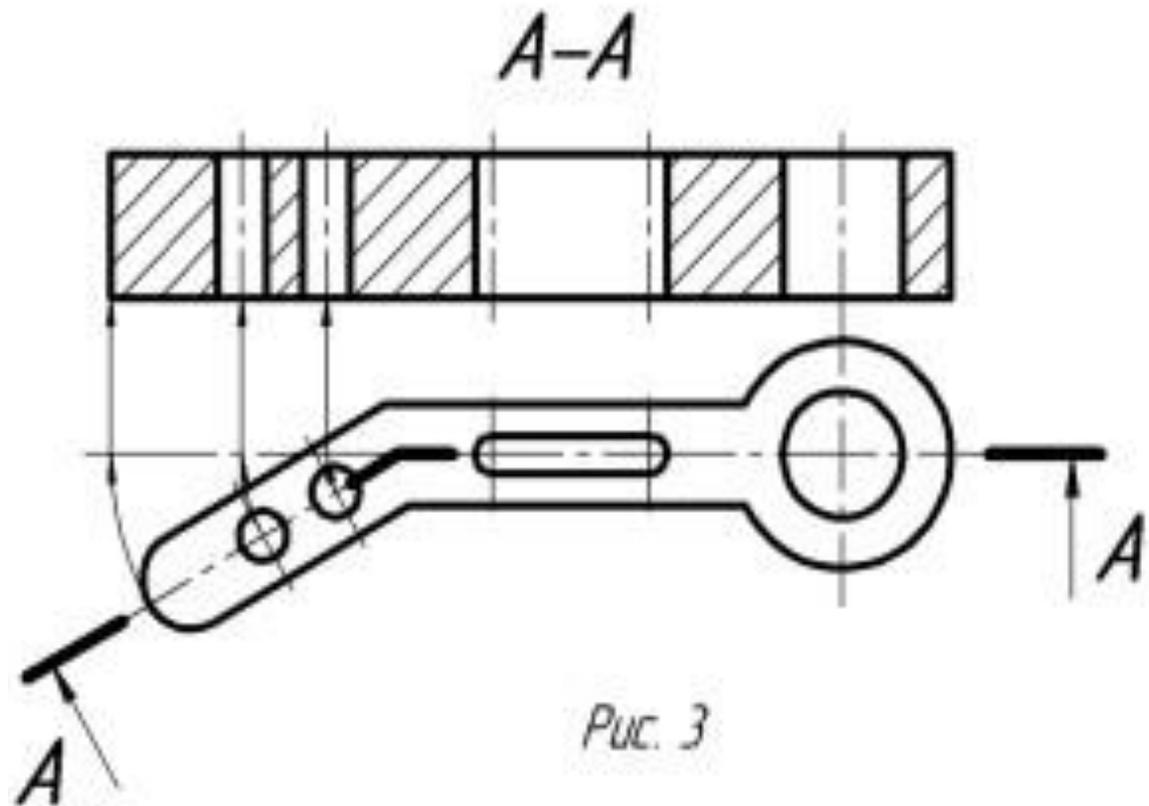
**Фигура сечения, входящая в разрез,
