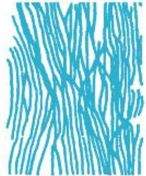
расположение макромолекул целлюлозы в природных волокнах(вата)
