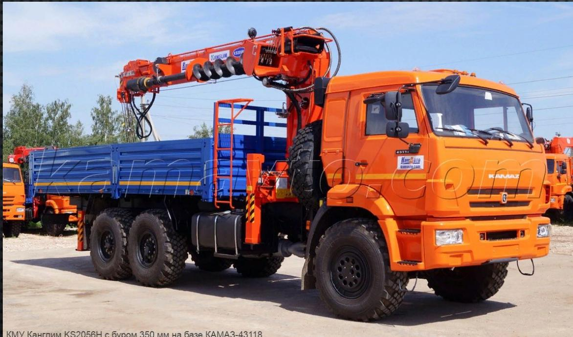
КМУ Канглим KS2056H с буром 350 мм на базе КАМАЗ-43118
