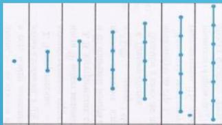
**Соединитель** - деталь синего или желтого цвета, соединяет токоведущие радиодетали между собой согласно, схемы. Выполняет, роль проводов в устройстве
