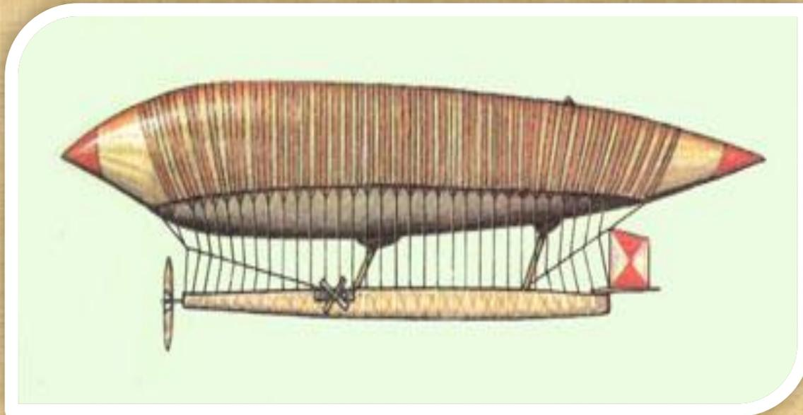
В 1884 году — дирижабль «Франция» Ш. Ренара и Ал.Кребса объёмом ок. 2 тыс. м<sup>3</sup>. По существу эти полёты были первыми управляемыми. Для поддержания удлинённой обтекаемой формы корпуса дирижабля использовались баллонеты. Кроме рулей направления в конструкцию оперения дирижабля стали включать и стабилизаторы. Наряду с мягкими дирижаблями начали проектировать, а затем и строить жёсткие и нежёсткие дирижабли.
