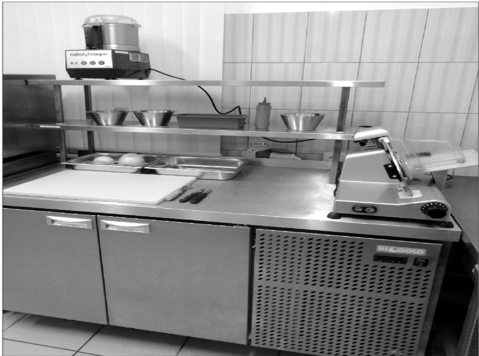
Рис. 2.10. Организация рабочего места по приготовлению холодных сладких блюд (стол с охлаждаемым шкафом, полками для хранения настольного оборудования, механизмов, инвентаря, инструментов, куттер, слайсер, разделочная доска для фруктов, гастоуремкости, ножи, инструменты)
